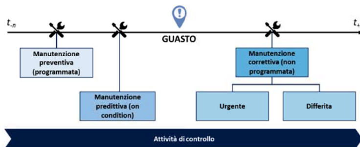
Figura 8 - Tipologie di manutenzione adottate dalla Concorrente
