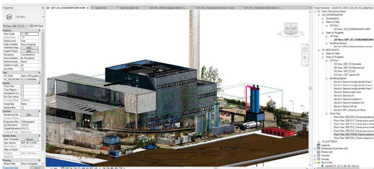
Figura 9 - Sovrapposizione del modello dello stato di progetto con il rilievo 3D (nuvola di punti) e inserimento della topografia tridimensionale – Trieste, Revamping WTE
