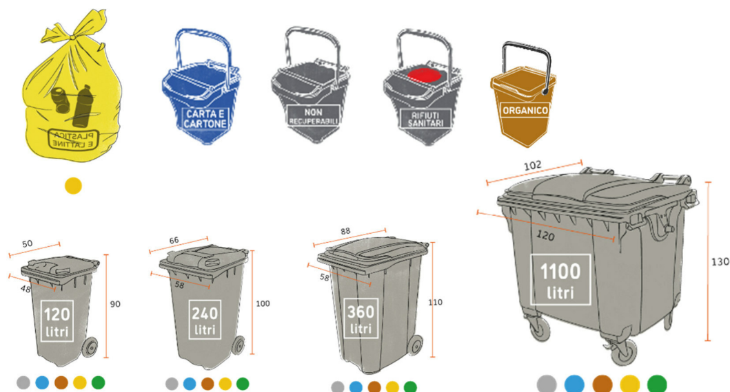
Figura 1: esempio di volumetria e dimensione (cm) dei contenitori adibiti alla raccolta dei rifiuti con modalità "porta a porta".
