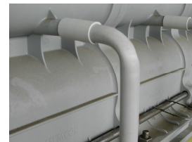
Figura 6: Rimozione del Tubo per l'aria MemJet
