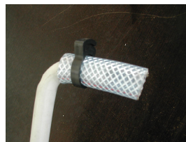
Figura 6: Rimozione del Tubo per l'aria MemJet
