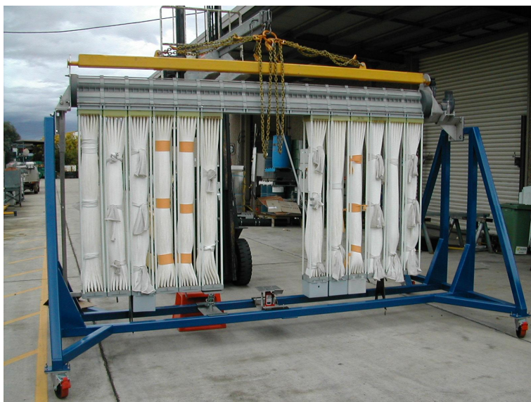
Figura 4: Un supporto per Rack MBR con un insieme di componenti del Rack parzialmente smontato agganciato.
