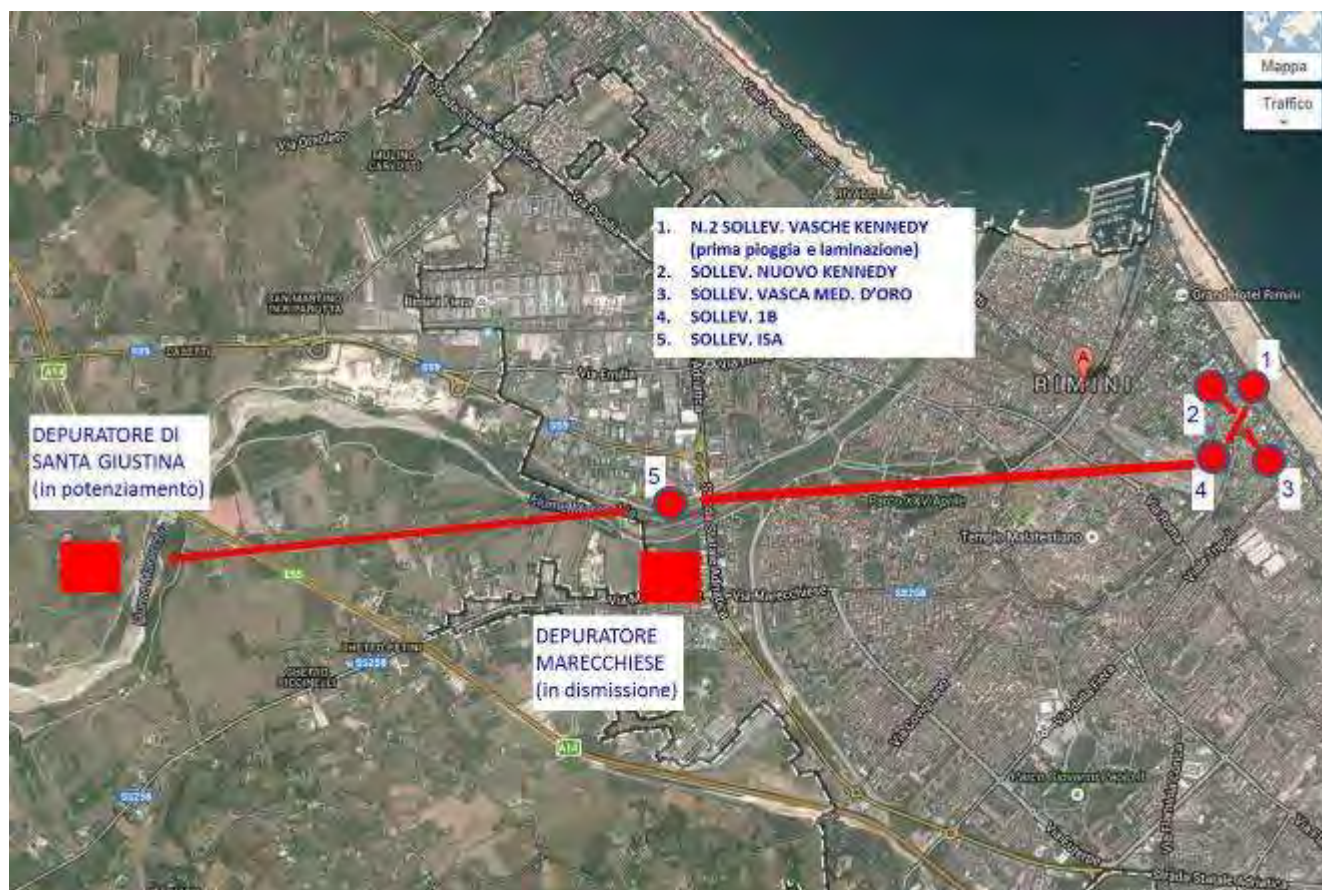
Figura 3. Rappresentazione schematica percorso idraulico reflui dalle Nuove Vasche fino all'Impianto di depurazione di Santa Giustina.
