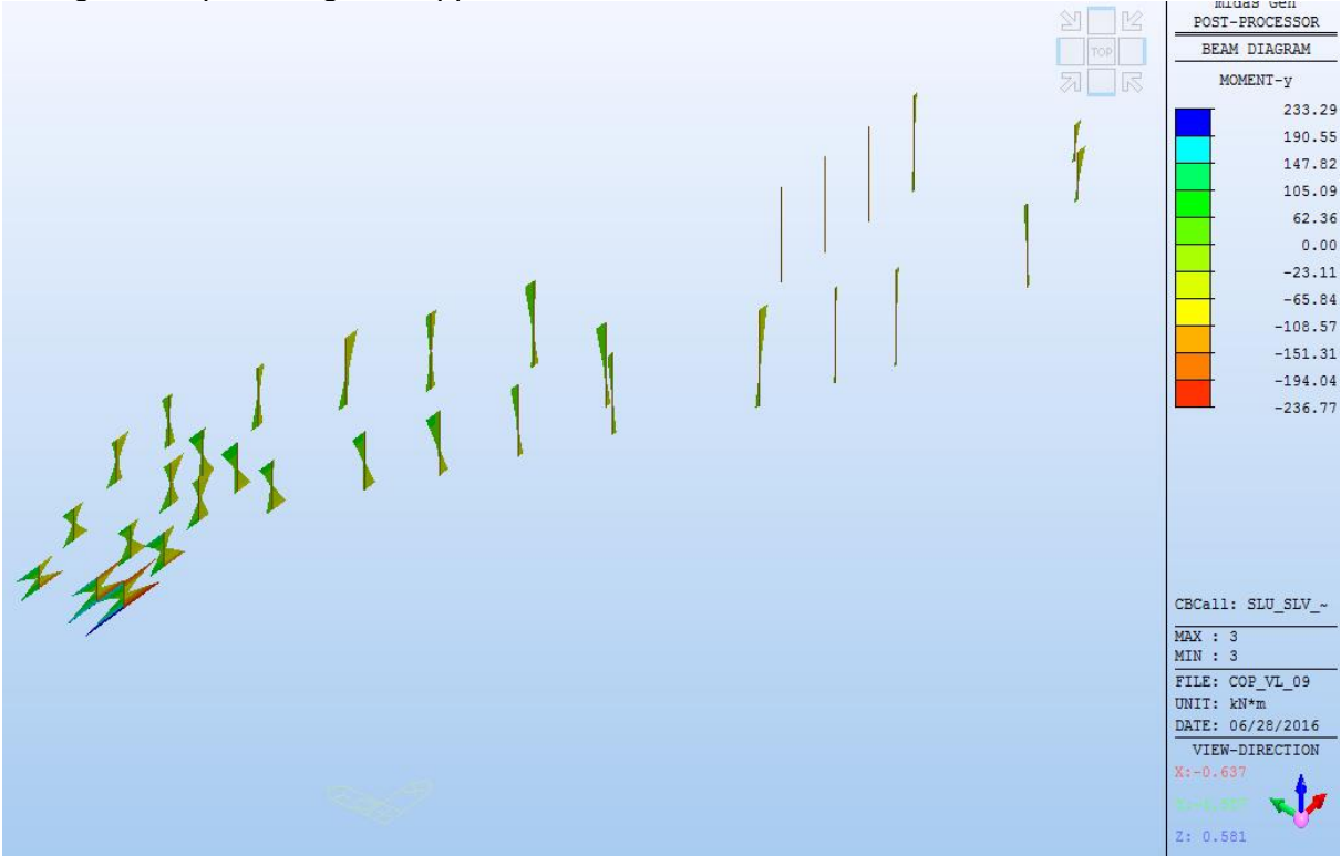
Figura 72. Copertura Fuori Terra Vasca di Laminazione – Inviluppo Momenti My Pilastri
