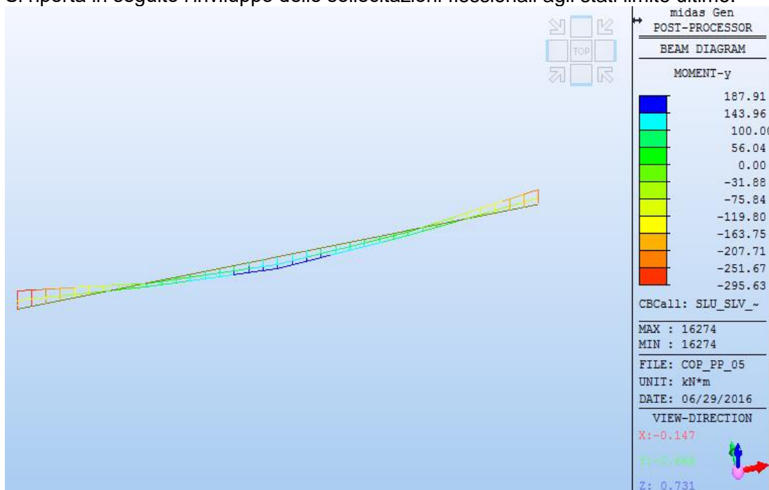
Figura 49. Copertura Fuori Terra Vasca di Prima Pioggia – Involuppo Momento M_y Comb. SLU e SLV Trave Zona Botole
