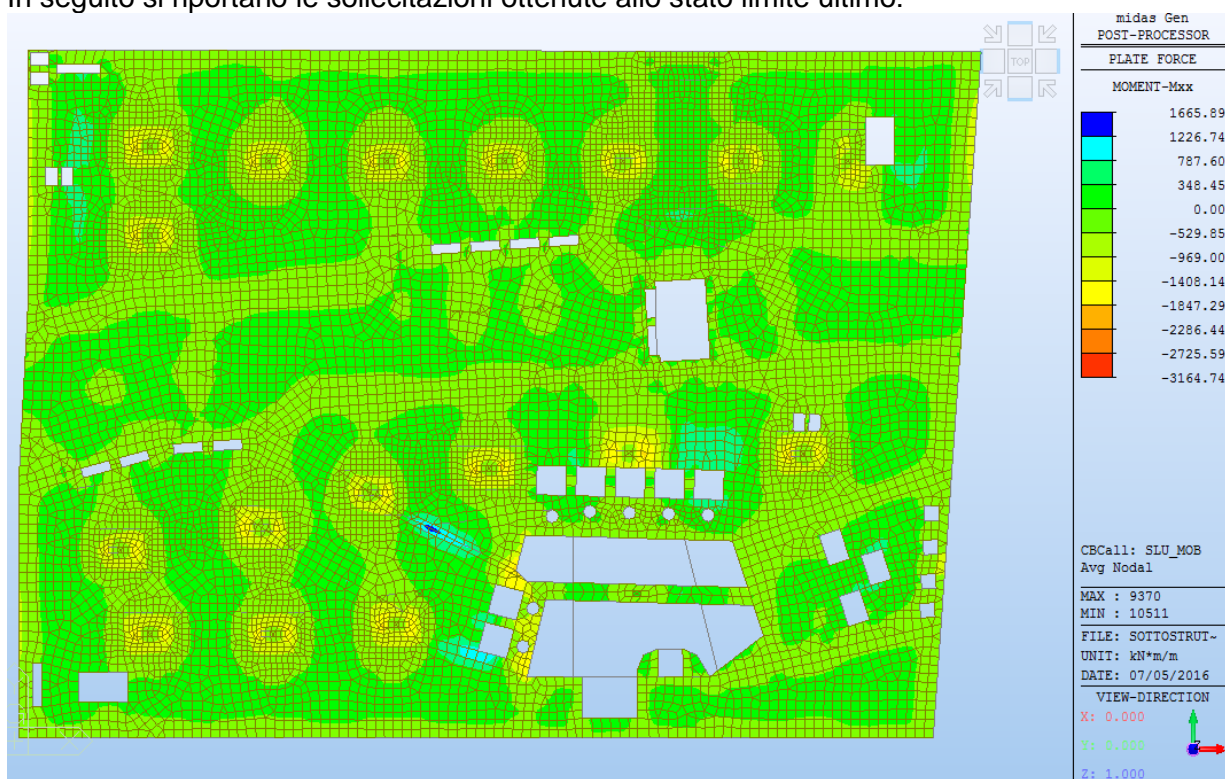
Figura 140. Copertura Vasche – Inviluppo Momenti Mxx – SLU con Carichi Mobili
