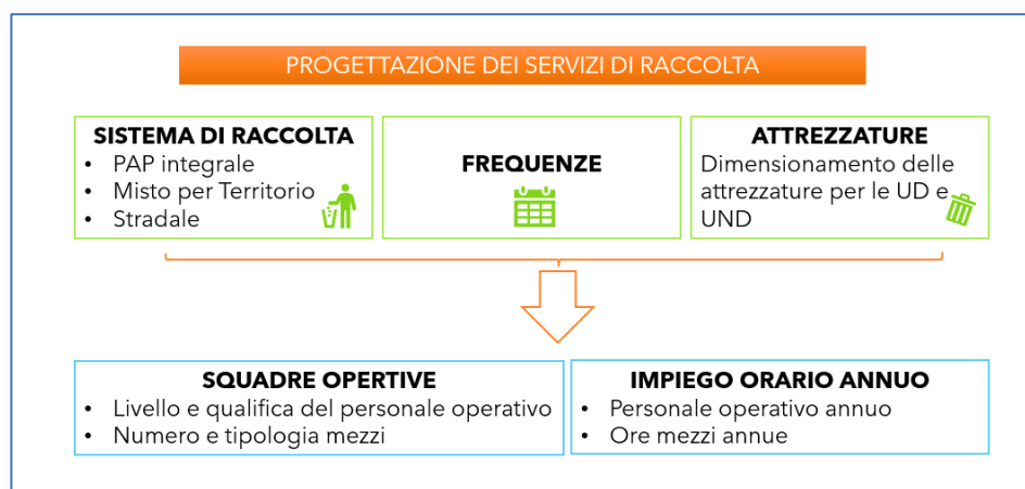
Figura 3.19 Dimensionamento tecnico dei servizi di raccolta
