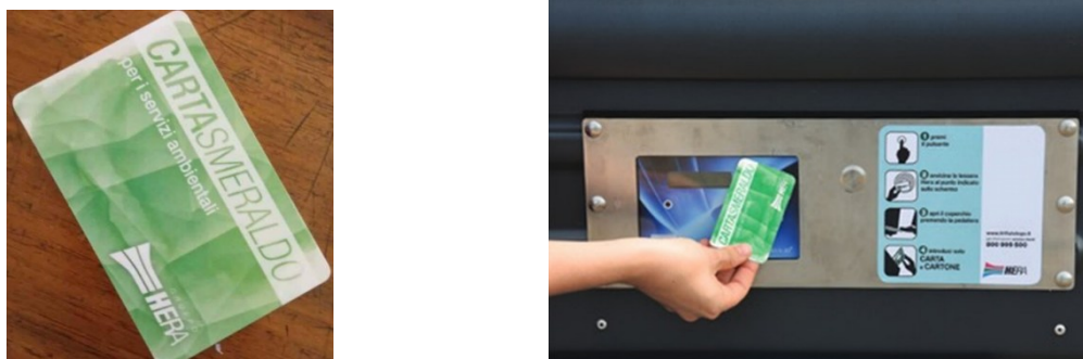
Figura 2.13 Lettura di un transponder durante le operazioni di svuotamento di un contenitore dei rifiuti indifferenziati in area servita porta a porta
